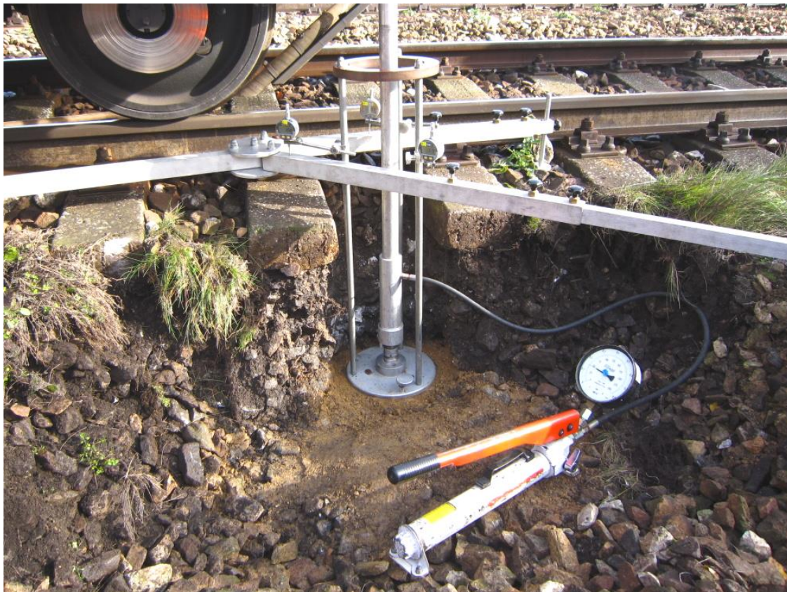
Obr. č. 30 Kopaná sonda KS 55,897 (kolej č. 1)
