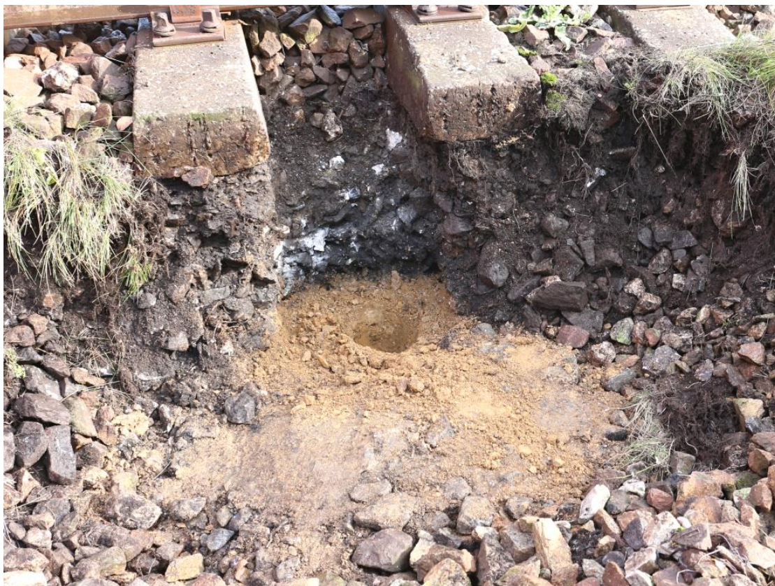
Obr. č. 31 Kopaná sonda KS 55,897 (kolej č. 1) - detail dna sondy
