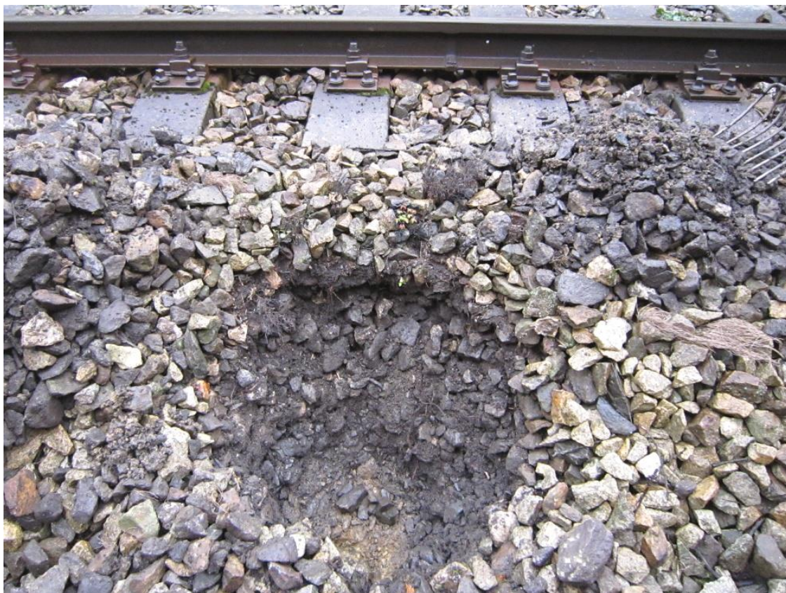
Obr. č. 49 Kopaná sonda KS 59,640 (kolej č. 1) - odběr vzorku k chemické analýze
