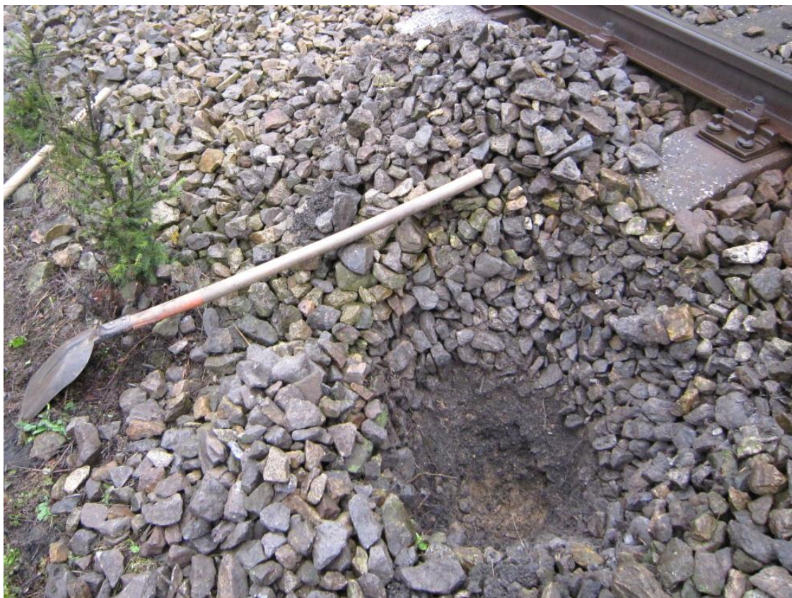
Obr. č. 45 Kopaná sonda KS 59,000 (kolej č. 2) - odběr vzorku k chemické analýze
