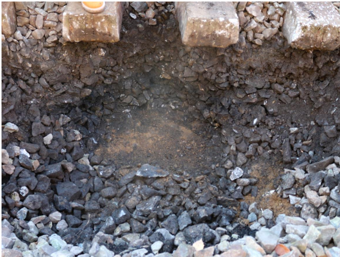
Obr. č. 22 Kopaná sonda KS 55,000 (kolej č. 2)
