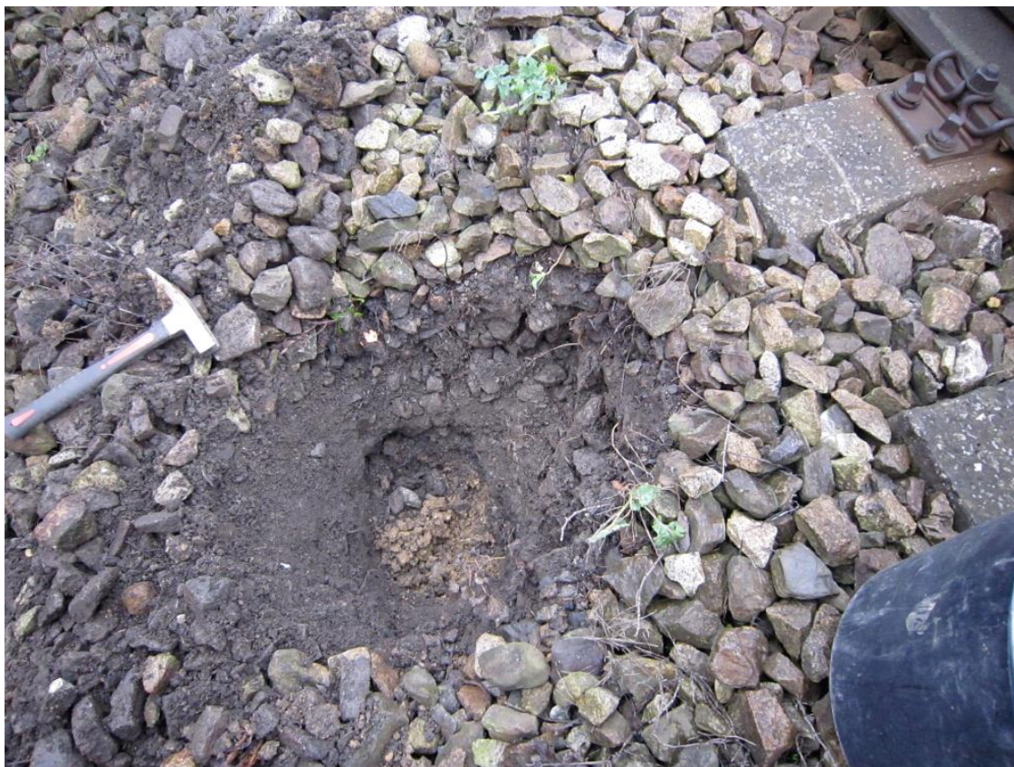
Obr. č. 3 Kopaná sonda KS 51,000 (kolej č. 2) - odběr vzorku k chemické analýze
