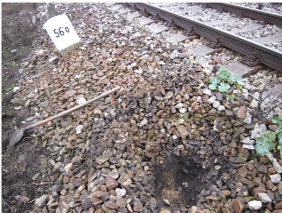
Obr. č. 32 Kopaná sonda KS 56,000 (kolej č. 1) - odběr vzorku k chemické analýze
