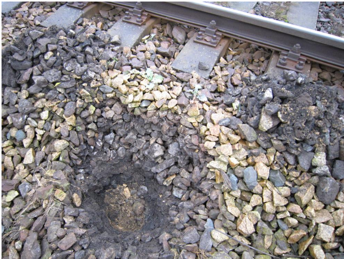
Obr. č. 52 Kopaná sonda KS 60,900 (kolej č. 2) - odběr vzorku k chemické analýze
