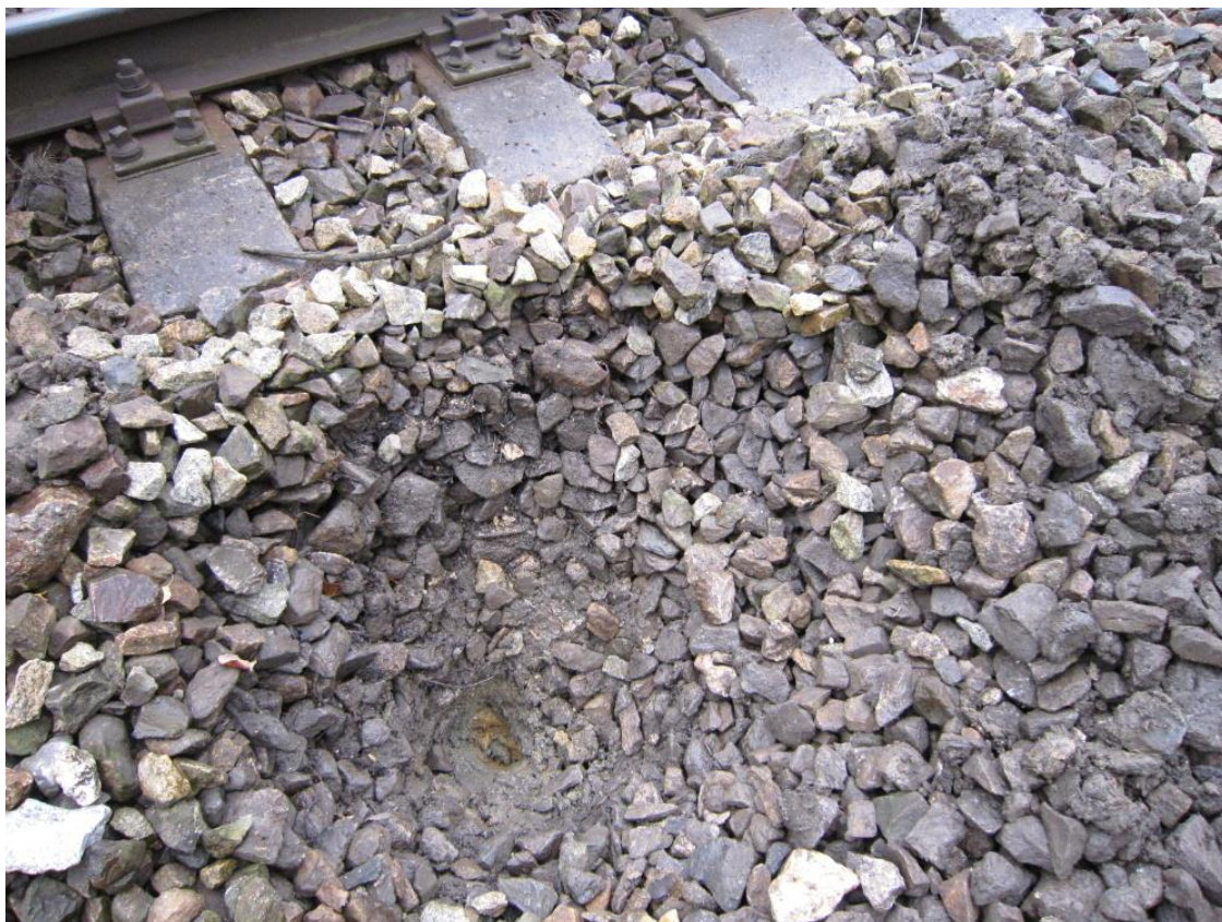
Obr. č. 7 Kopaná sonda KS 52,000 (kolej č. 1) - odběr vzorku k chemické analýze
