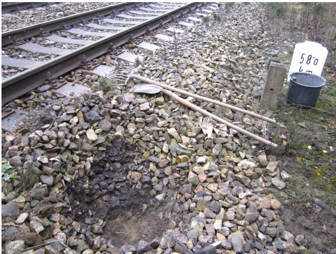
Obr. č. 39 Kopaná sonda KS 58,000 (kolej č. 1) - odběr vzorku k chemické analýze
