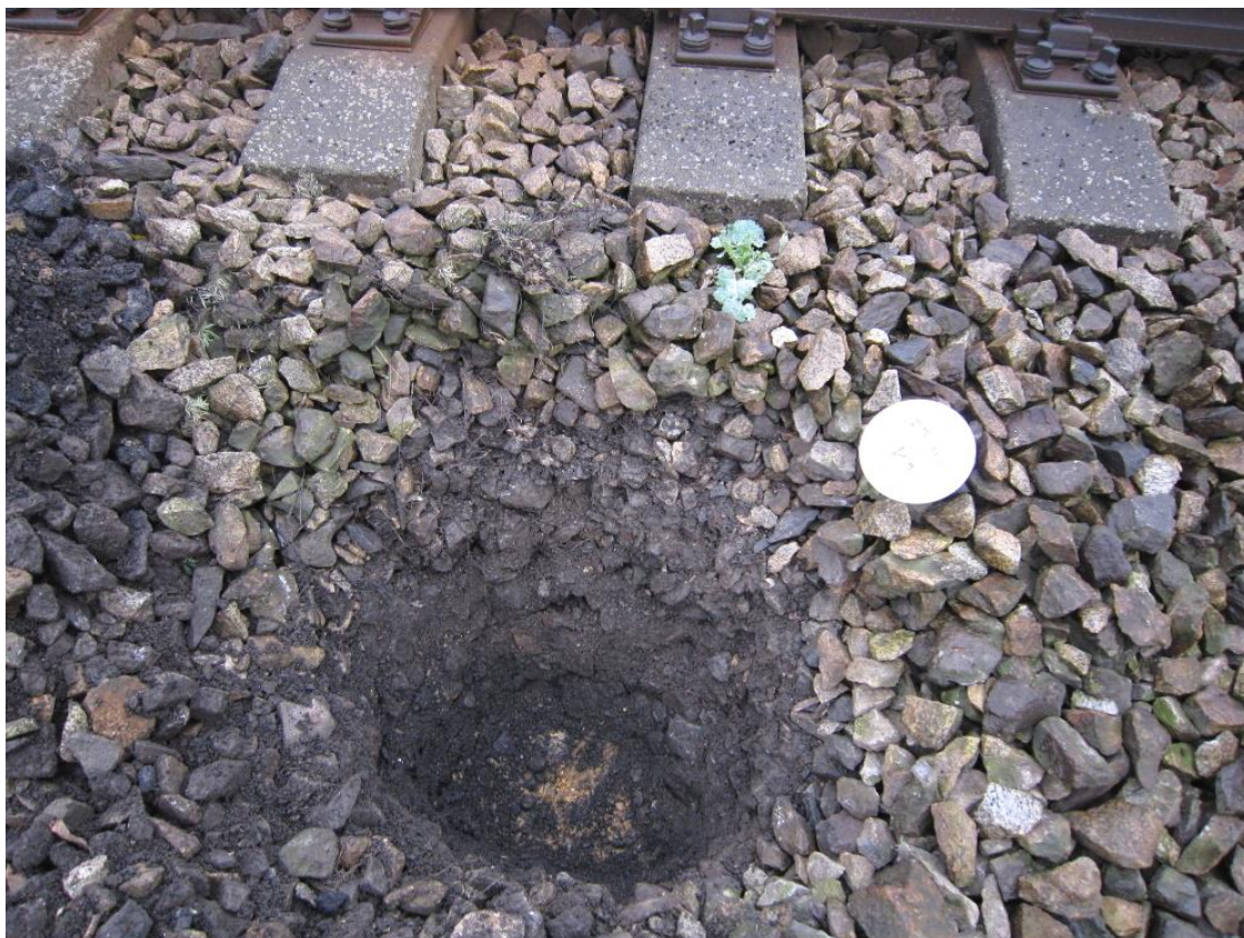
Obr. č. 11 Kopaná sonda KS 53,100 (kolej č. 2) - odběr vzorku k chemické analýze
