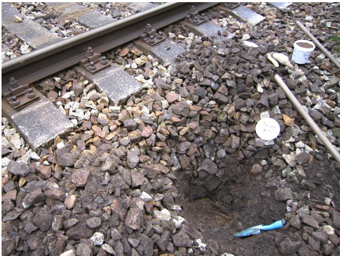
Obr. č. 19 Kopaná sonda KS 54,125 (kolej č. 1) - odběr vzorku k chemické analýze
