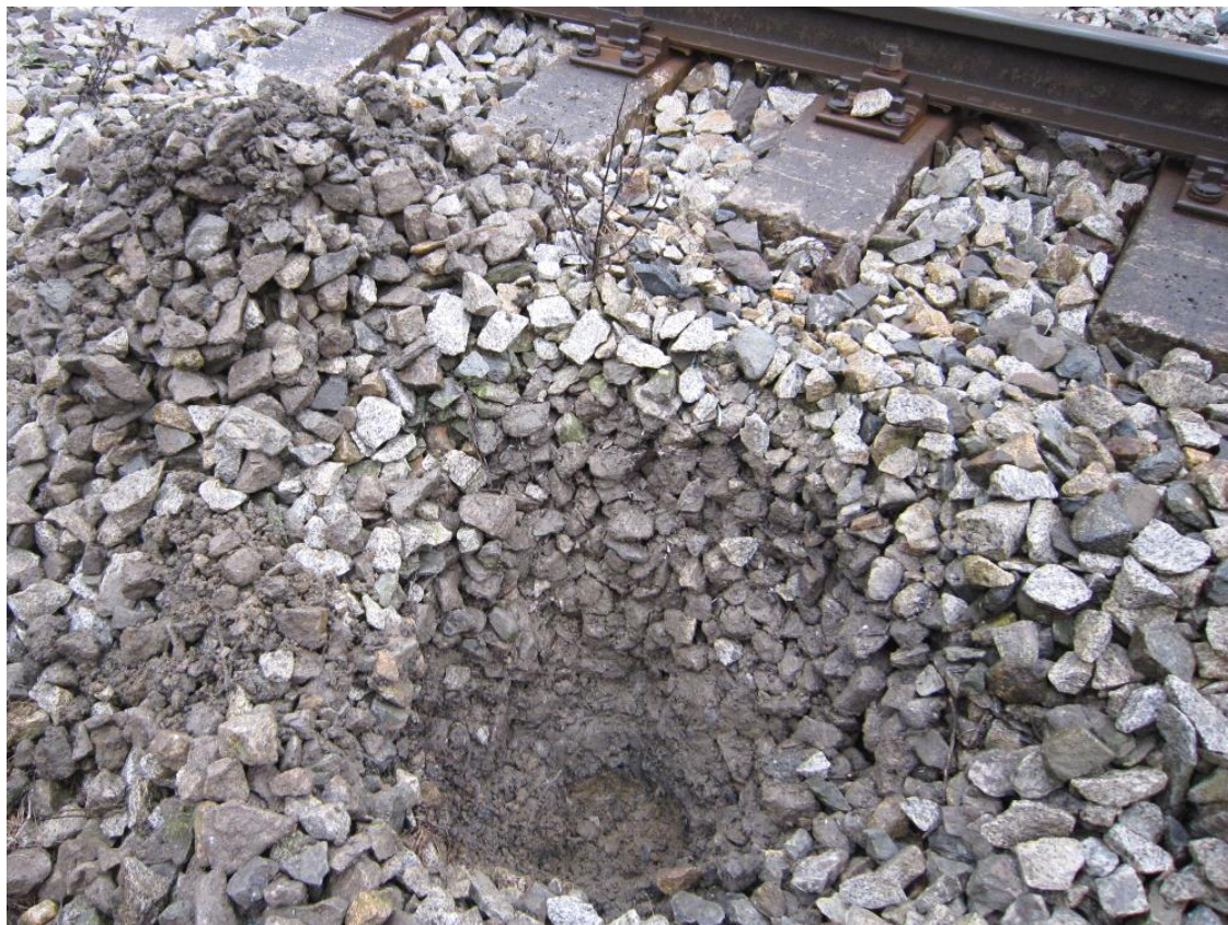
Obr. č. 36 Kopaná sonda KS 56,800 (kolej č. 2) - odběr vzorku k chemické analýze
